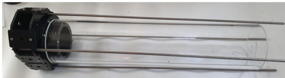
Le tube est démonté, la carte SD peut être retirée, et/ou les piles changées.
