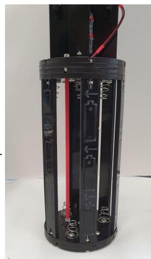
Ne pas oublier de placer la pile de la colonne centrale, orienté + vers le bas et - vers le haut.
